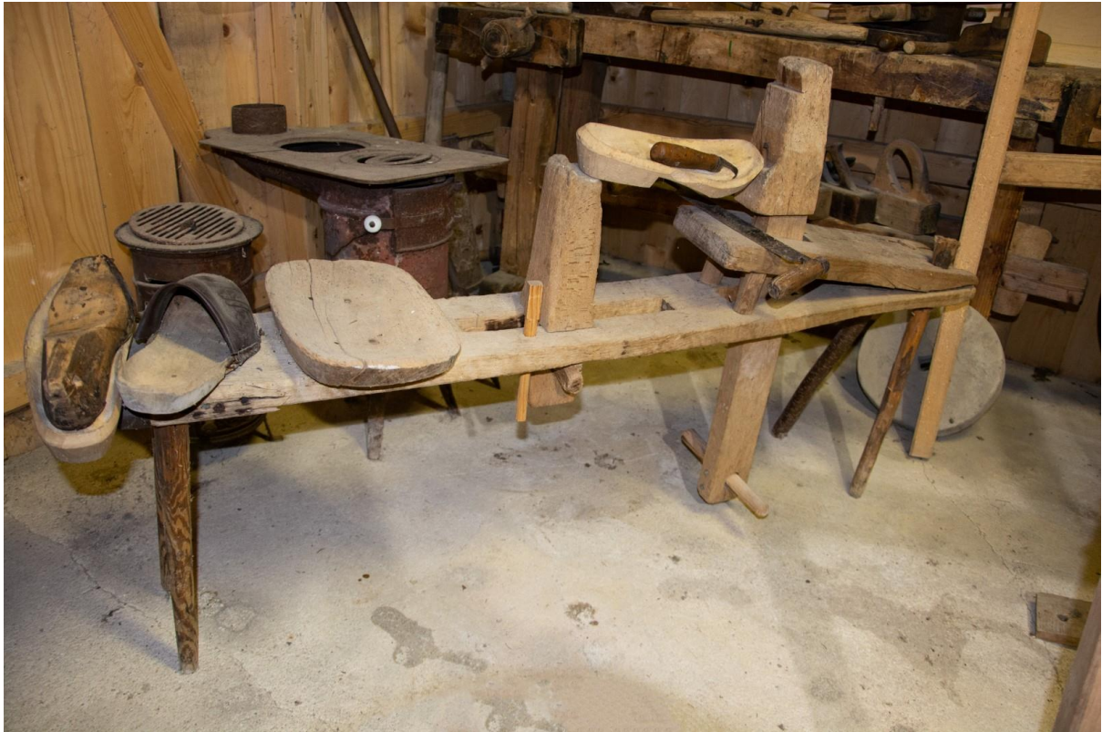
Foto 16 Lesena priprava in orodje za izdelovanje coklov.
